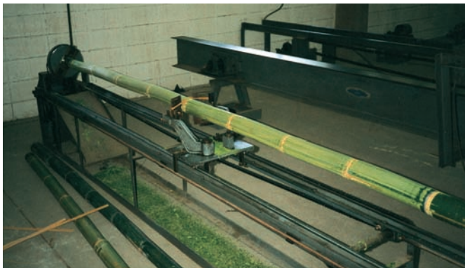
1. Abschleifen der vorstehenden Nodienbereiche
