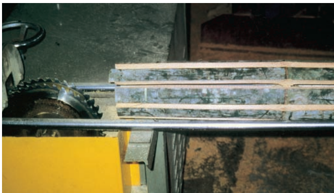
3. Radiales Auftrennen des Halmes in Lamellen
