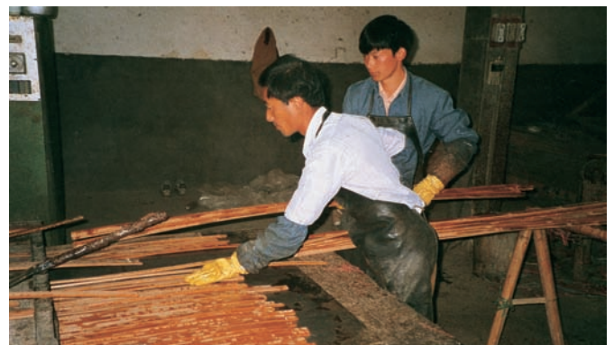
6. Beleimen der Lamellen einer Platte
