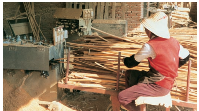
4. Glätten der Lamellen mit Abrichte
