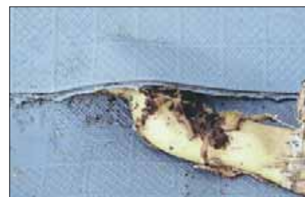
Rhizom-Eindringung in eine Naht bei der TPO-Bahn 1,6 mm ( Phyllostachys humilis , Januar 2006)
